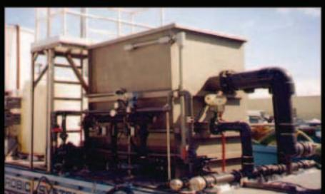
AquaDisk® Pilot預測試操作試驗
